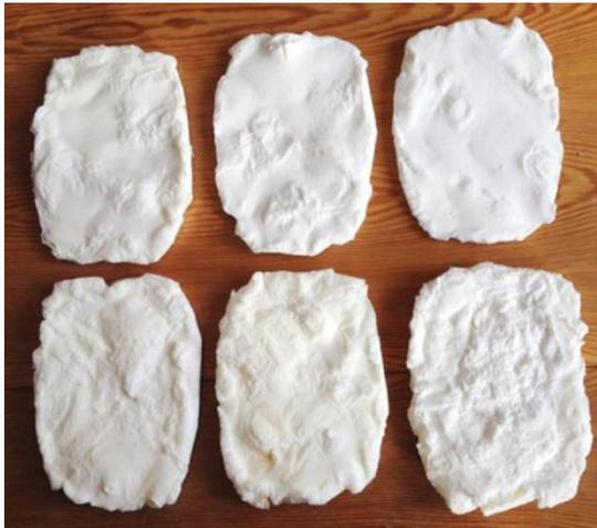
**Slika 3** Izgled konstruktivnog materijala na bazi soli
