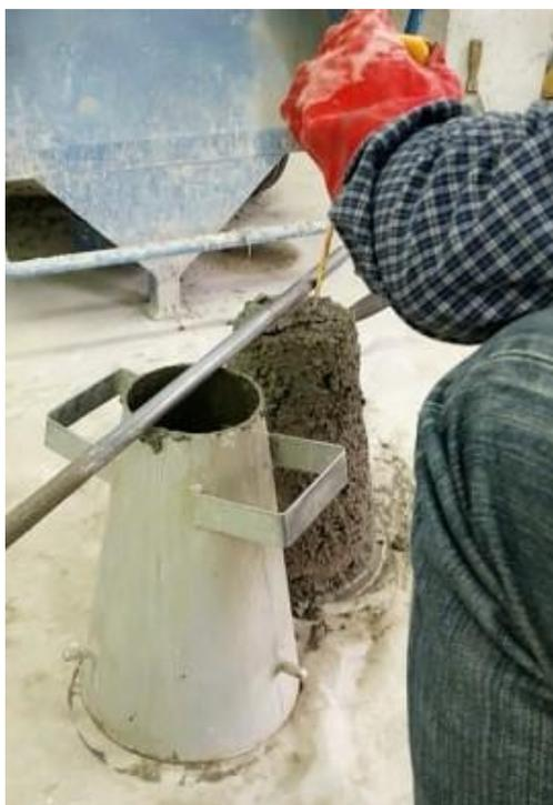
**Slika 2:** Mjerenje veličine slijeganja na uzorku ETALON LP
