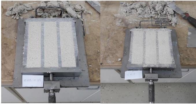
**Slika 5:** Ispitne mješavine vapnenog morta s dodatkom recikliranog betona
